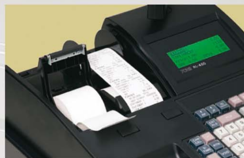
Sistema de carga de papel "Drop-In" (Soltar dentro) que permite una carga de papel instantánea.
